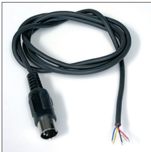
K-DIN-ST5M: Kabel mit DIN-Stecker, 5-polig, männlich, Länge ca. 1 m, Rundkabel, alle Adern gemeinsam abgeschirmt, Schirm am Kontakt 2
