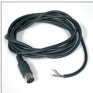
K-DIN-ST6M: Kabel mit DIN-Stecker, 6-polig, männlich, Länge ca. 2 m, Rundkabel, alle Adern gemeinsam abgeschirmt, Schirm am Kontakt 2
